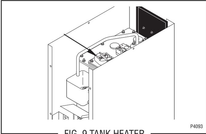
FIG. 9 TANK HEATER
